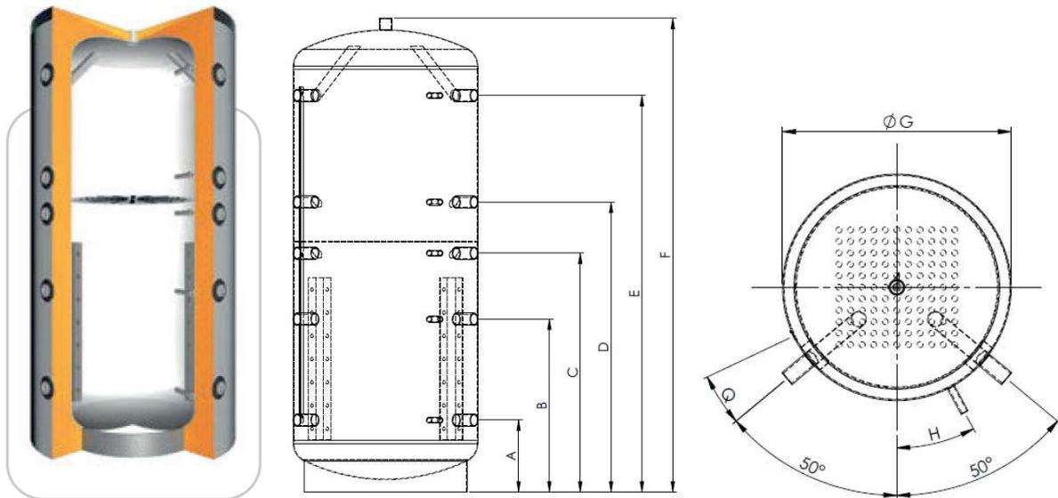
Kurzbeschreibung: 800l Heizwasserspeicher ohne Wärmetauscher mit Schichttrennblech.
